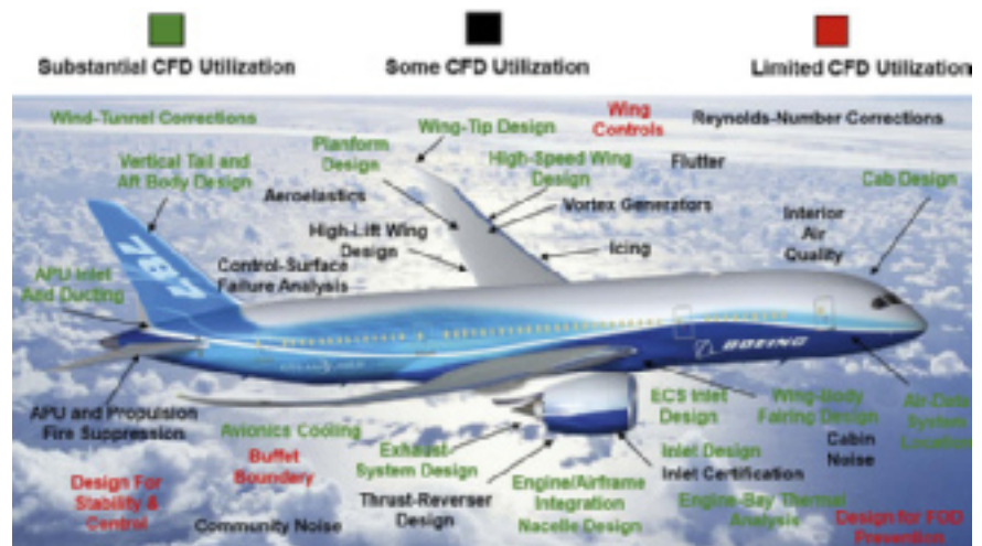
Figuur 1: Schematisch overzicht van delen die met CFD berekend worden. Groen is goed mogelijk. Zwart is al moeilijker. Rood is in de toekomst goed mogelijk.
